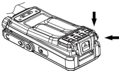
欲取下电池，请先将手持终端关机，然后将手持终端背面底部的门锁向上推，把整块电池取出。
