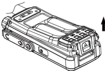
**注：请勿在手持终端处于开机状态下插、拔电池。**
